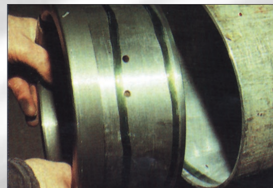
Piesa interioară și manșonul sunt fixate cu Loctite 638. Găurile filetate și de trecere și șuruburile nu mai sunt necesare.
