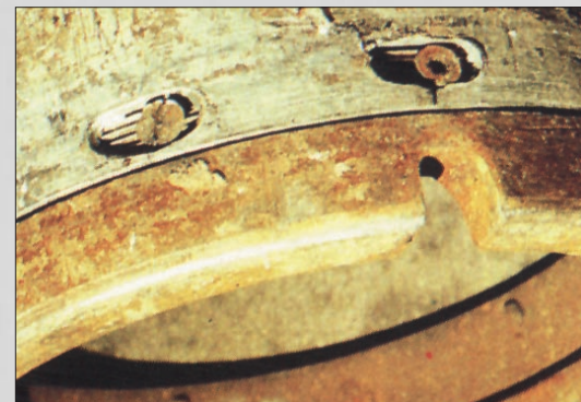
Fixarea cu adeziv a arborelui în bucușă de susținere a tamburului a economisit 1,5 ore de uzinare pe strung.
