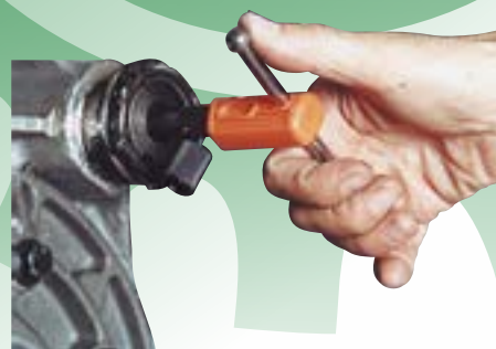
Dispozitivul IUS INTERIOR este disponibil în 9 dimensiuni asigurând reparația filetelor interioare cu diametre cuprinse între 8 mm (5/16") și 108 mm (4 1/4").
