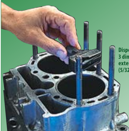
Dispozitivul IUS INTERIOR este disponibil în 9 dimensiuni asigurând reparația filetelor interioare cu diametre cuprinse între 8 mm (5/16") și 108 mm (4 1/4").
