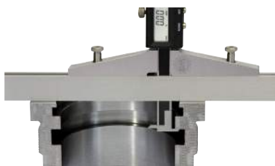
Anwendung mit verschiebbarer Messbrücke Application with moveable measuring bridge
