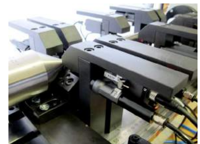
Mehrstellenmessvorrichtung für Präzisionswellen Multi-position measuring system for precision shafts
