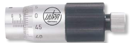
Ablese 0,005mm, Spindelsteigung 0,5mm (100 Teilstriche auf der Trommel)
