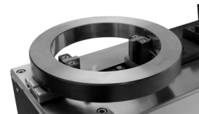
Messung von Innendurchmessern Measurement of inside diameters
