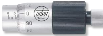
Ablese 0,01mm, Spindelsteigung 1,0mm (100 Teilstriche auf der Trommel, Ablese ohne Addition)
