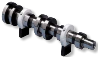
Einstellmeister PKW Kurbelgehäuse 4 Zylinder für die Automobilindustrie.
