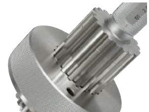
Kegelige Meisterverzahnungslehrrorne zum Prüfen der Abnutzung von Verzahnungslehrringen während des Prüfprozesses in der Fertigung. Tapered spline master plug gauges to monitor the wear of spline ring gauges during component manufacture.
