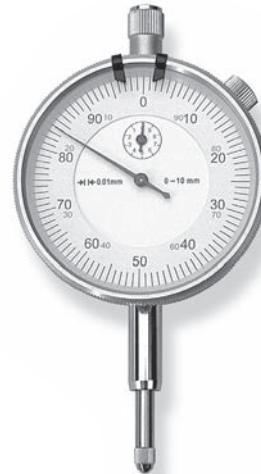
621.110 – Messuhr-Empfehlung • dial indicator recommendation
